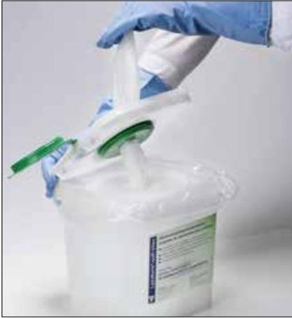
4. Deckel öffnen und Vliestuch aus der Mitte durch die Öffnung des Deckels führen. Anschließend Eimer und Deckel sorgfältig verschließen.
